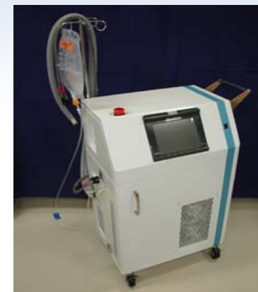
冷却水循環装置(機器)
