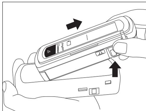
5. 新しいバンパーを用意します。ドライブユニットの下側からバンパーに挿入します。
